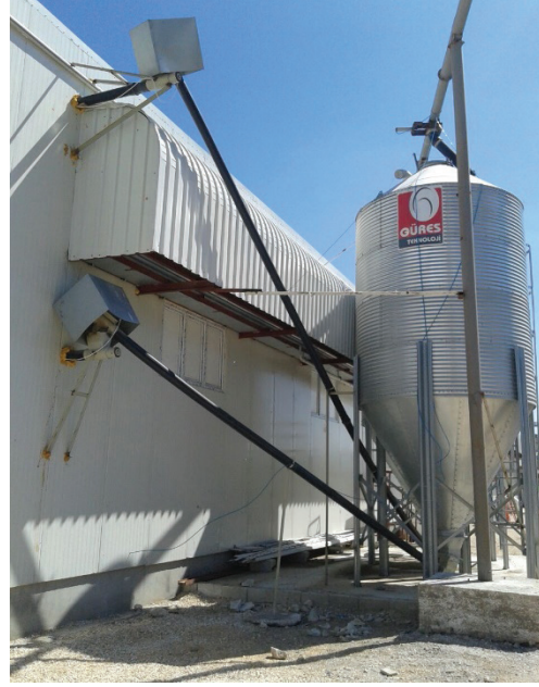
Şekil 20. Kafeslere yem dağıtma arabası ve kümes yem silosu
