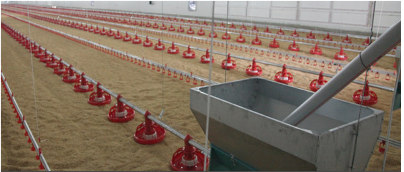
Şekil 12. Kümes içi spiral yemleme sistemi ve elemanları
