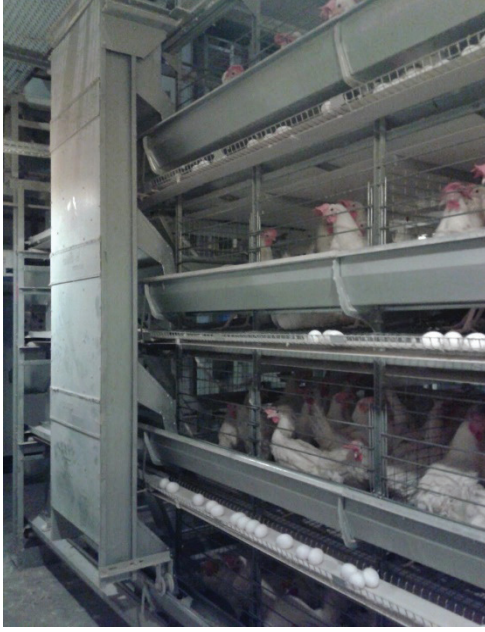
Şekil 20. Kafeslere yem dağıtma arabası ve kümes yem silosu
